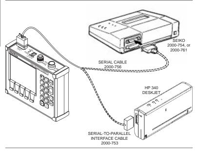
Figure 2-9. Printer Setup
